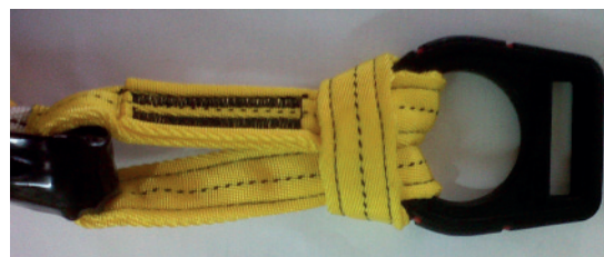
Uso correcto de amarre del anillo de cinta poliéster con la anilla dieléctrica del arnés.
