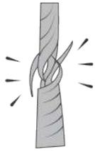
El cable de acero debe de ser revisado constantemente, si se detectan daños, reemplazarlo por otro.
