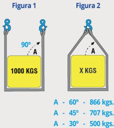
Una eslinga con capacidad para levantar 1,000 kilogramos en un arreglo vertical de 90 grados (Figura 1), solamente podrá levantar lo siguiente con el efecto eslinga en ángulo horizontal (Figura 2).
